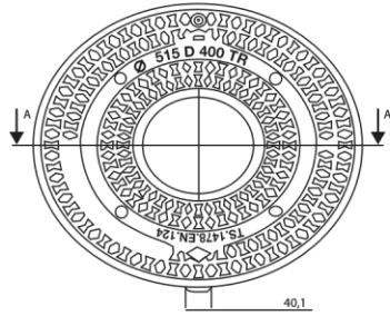
Rögar Kapağı Çerçevesi A-15 B-125 C-250 (Çap 515 mm) Ağırlık: min.11.5 kg
